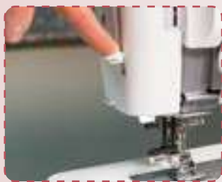
enfile aiguille supérieur intégré
